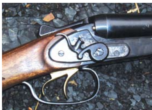
Оружие с внешними курками практически всегда имеет два спуска.
