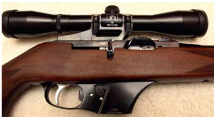
МЦ-18 имеет оригинальный затвор двойного действия, винтовка может работать как полуавтомат и как «болт».
